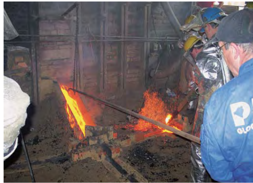
Glockenguss in Passau: Nach dem Anstich des Gussofens schießt die flüssige Bronze wie glühendes Lava durch die vorbereiteten Kanäle und füllt nacheinander die Glockenformen. Foto: Hildenstein
